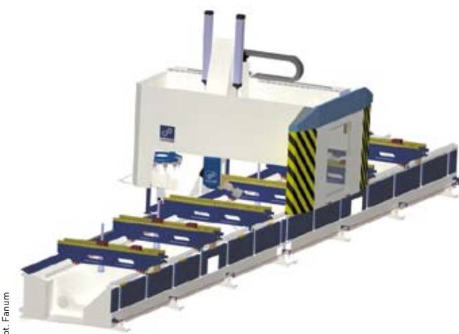
Omega to centrum 5-osiowe o stałym stole, ale ruchomej bramie, na której zamontowany jest suport osi Y i Z.
