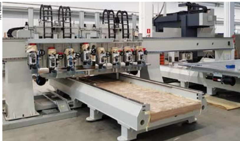
Konstrukcja suportu głowicy roboczej wykonana została z płyt i kształtowników stalowych oraz z odlewów aluminiowych.
