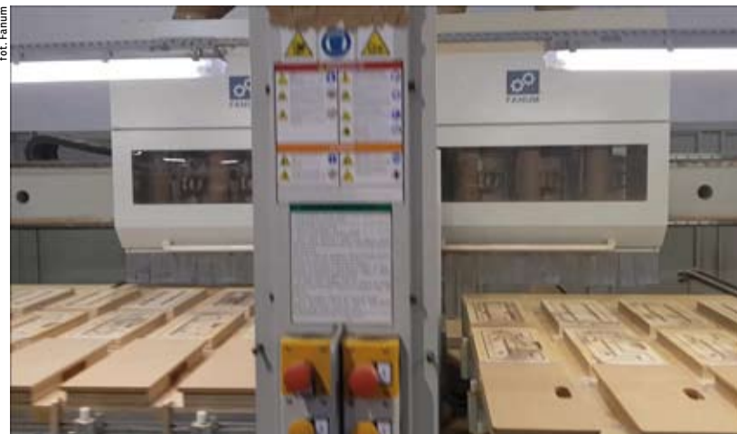
Konstrukcja i wyposażenie tego centrum obróbkowego Fanum zapewniają możliwość prowadzenia wydajnej i dokładnej obróbki elementów o skomplikowanych kształtach, na dwóch stołach.
