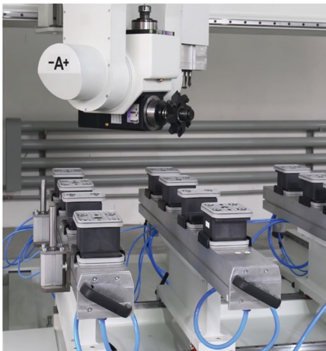
Maszyna Sigma z głowicą specjalną oraz belkowym stołem podciśnieniowym, wykonana na specjalne zamówienie producenta mebli skrzyńowych. Głowica zawiera elektrowrzeciono z automatycznym systemem wymiany narzędzi i odrębny agregat wiertarski.
